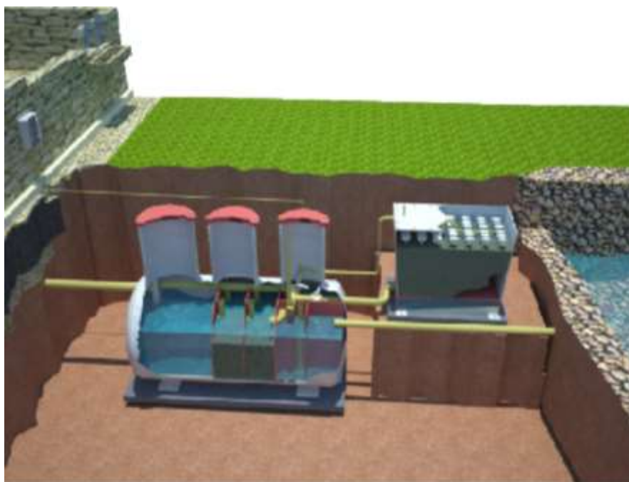
Hình 3.3: Bể xử lý nước thải tại chỗ chế tạo sẵn kiểu Modul Bastafat-F
